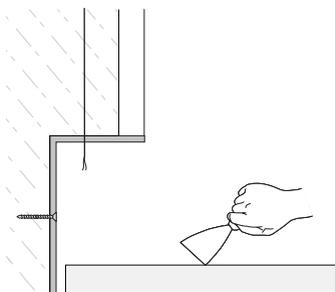
6 Уложите напольное покрытие с зазором 3-5 мм
