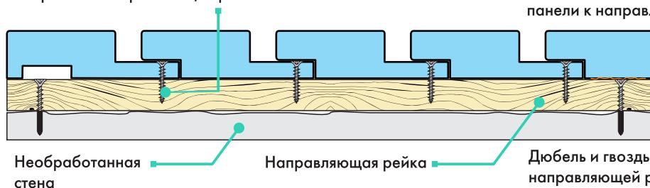
Саморез для крепления реечной панели к направляющей рейке
